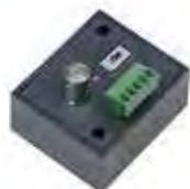
Trasmettitore attivo di segnale video AHD/TVI/CVI su cavo UTP Cat5e/Cat6, connettore tipo BNC per ingresso segnale video, terminali a vite estraibili per collegamento cavo UTP e alimentazione, distanza raggiungibile 600 m (AHD/CVI)/500 m (TVI) @ 1080p con ricevitore attivo art. AHUTP61RC, contenitore plastico, colore nero, alimentatore incluso.
